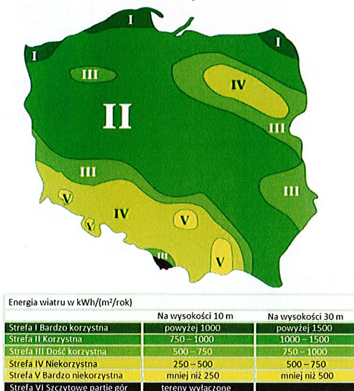
Rysunek 9. Energia wiatru w kWh/(m²/rok) na wysokości 10 i 30 m n.p.m.
